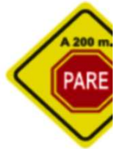
P33 (a) PROXIMIDAD SEÑAL RESTRICCIÓN (PARE)
