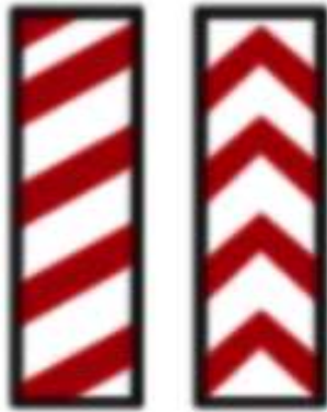
P2 (b) PANELES DE PREVENCIÓN (OB. RIG.)
