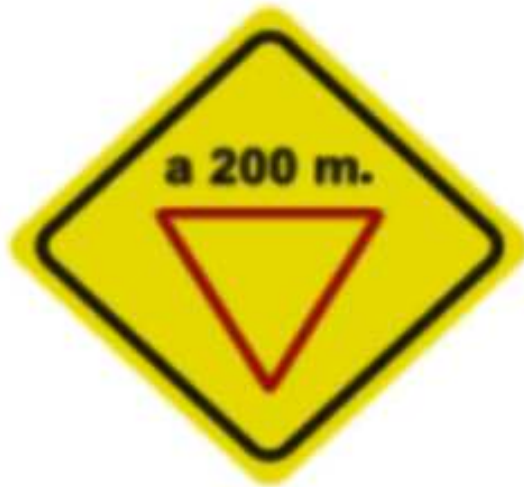
P33 (b) PROXIMIDAD DE SEÑAL RESTRICTIVA (PASO)
