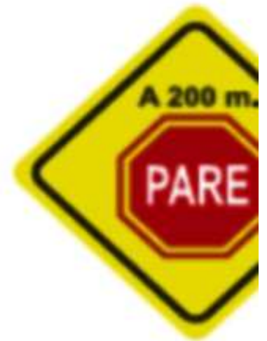
P33 (a) PROXIMIDAD SEÑAL RESTRICCIÓN (PARE)
